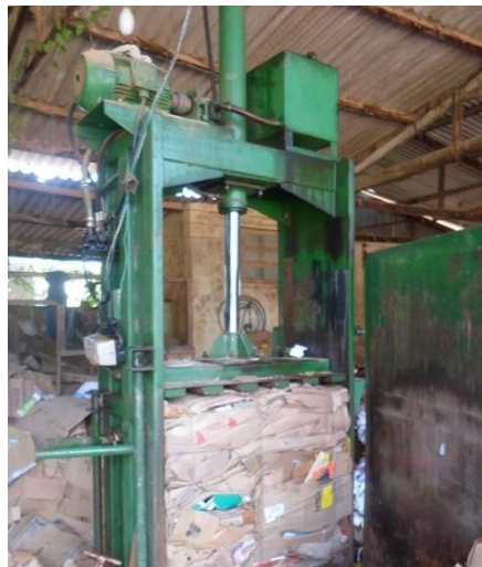
Figura 2 – Materiais posicionados na máquina de prensa. Fonte: Associação de Coleta Seletiva analisada.
